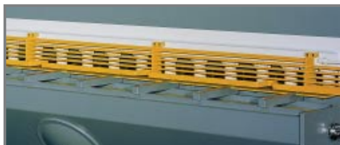
GRILLES SPÉCIALES pour couper des bandes fines.
