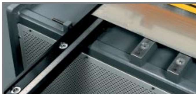
BILLES DANS LES CONSOLES , pour faciliter la manipulation des tôles.
